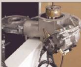
Verbrennungseinheit in Wartungsposition einhängen
